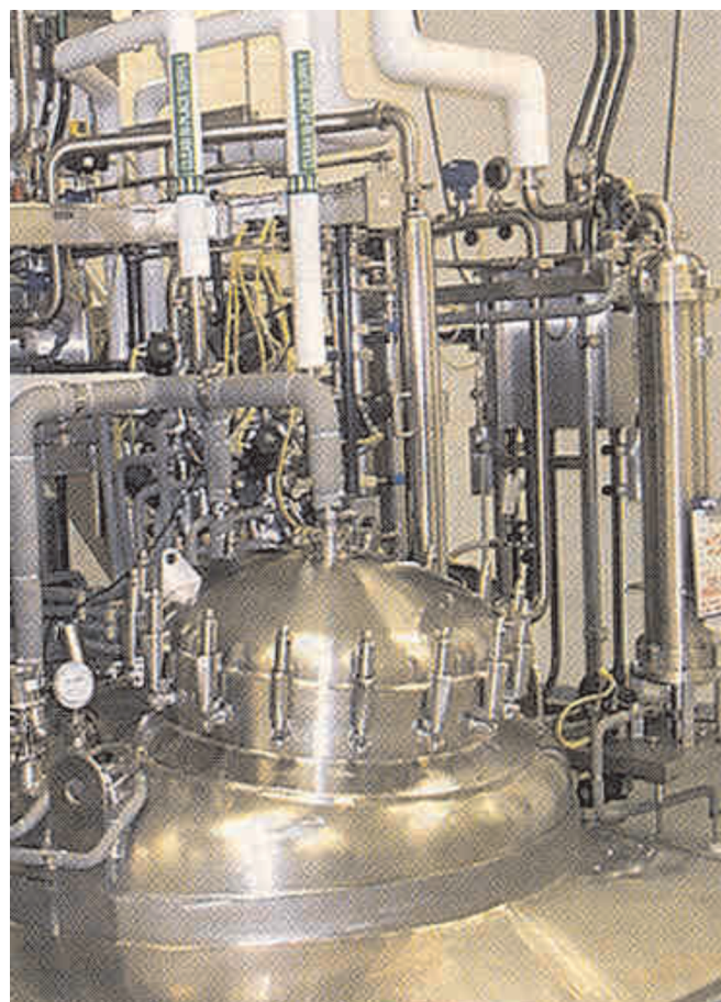
Рис. 4. Производство моноклональных антител на культуре клеток животных, выращиваемых в биореакторе, компанией Wyeth Biopharma (Andover, штат Массачусетс, США)
